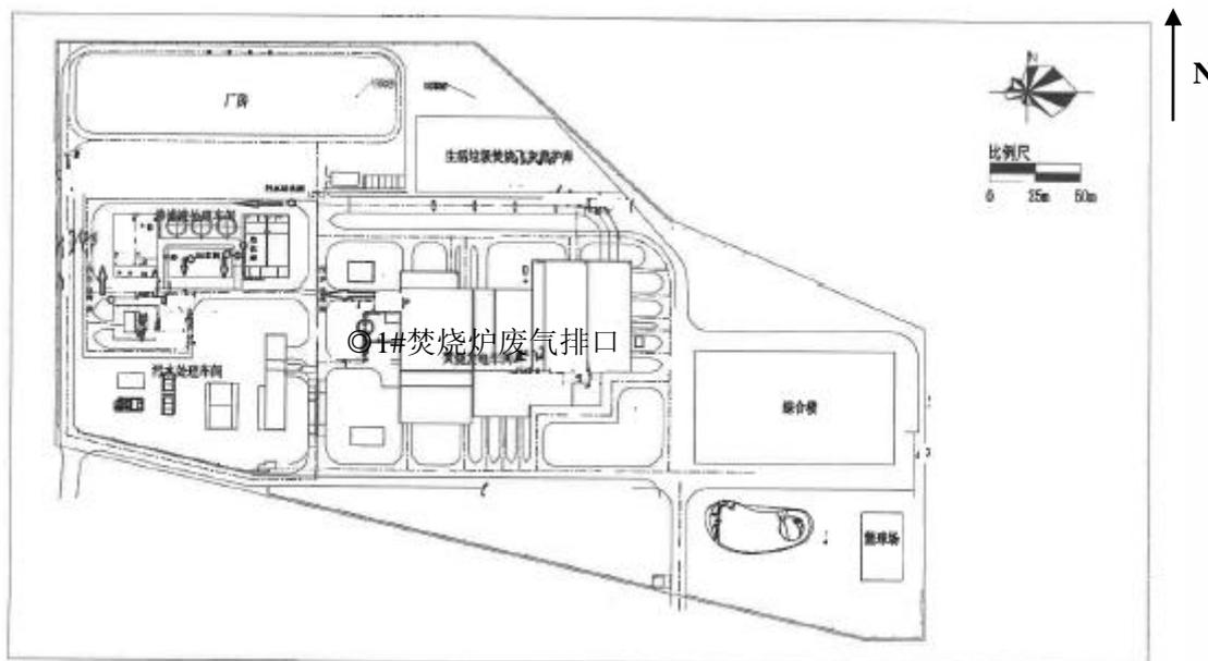
说明：◎焚烧炉废气采样点
